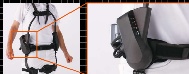
モーター搭載のギアボックス
